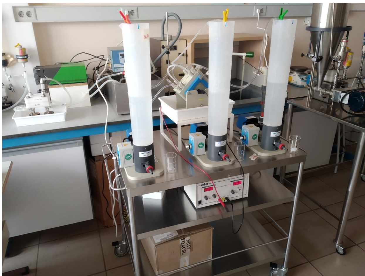
Figura 9. Instalación de electrodiálisis utilizada para los ensayos
