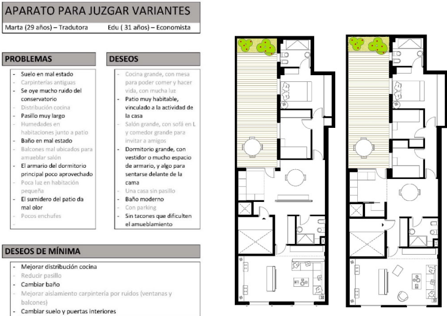
FIGURA 3. Aparato para juzgar variantes y propuestas en fase de sensatez elaboradas según el método Livingston para desarrollar un proyecto de reforma para una pareja de Sevilla en contexto del desarrollo del curso de Introducción a la Producción y Gestión Social del Hábitat del Centro de Formación Permanente de la Universidad de Sevilla.
