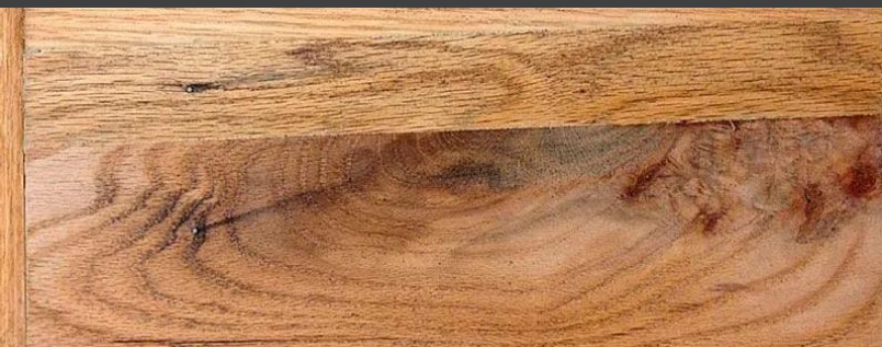
Manchas oscuras por concentración de taninos arrastrados por la humedad
