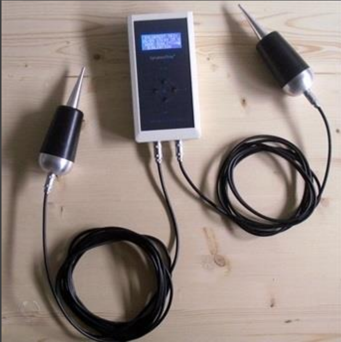
Equipo portátil de ultrasonidos Sylvatest TR10
