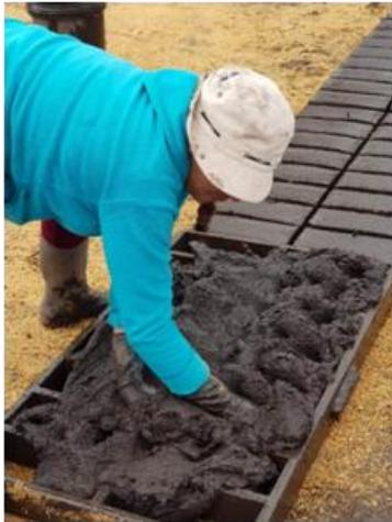
Figura 4.9. Colocando mezcla.
