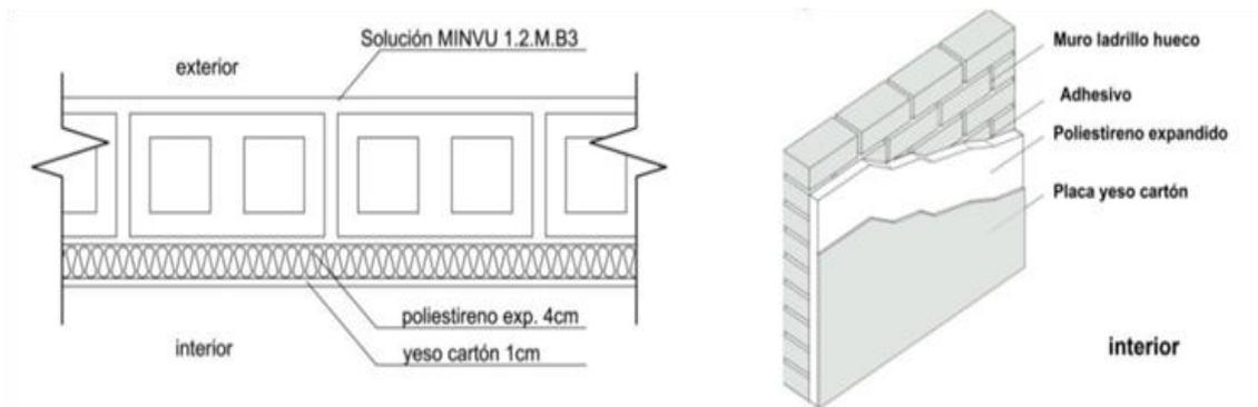
Figura 3.4.- Opción 1 de aislamiento térmico aplicado por el interior. Fuente: [24]
