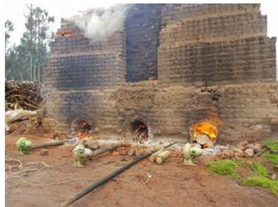
Figura 4.15. Sellado del horno.
