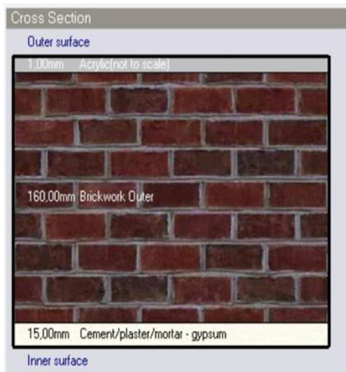
Figura 4.19. Ingreso de materiales de la fachada por capas y medidas en Design Builder.
