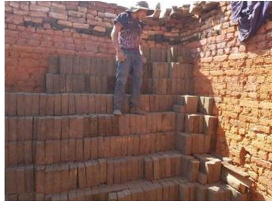
Figura 4.13. Apilado en el horno.
