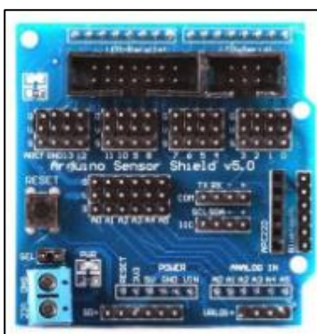
Figura 2.7: Placa Sensor Shield V5 [3]
