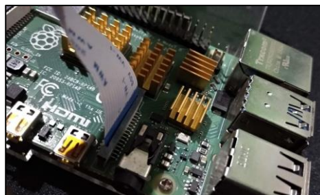
Figura 2.21: Conexión de cámara a Raspberry Pi [16]
