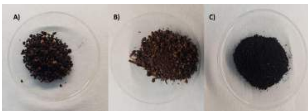
Figura 33: Muestras de: A) alperujo, B) alperujo compostado y C) biochar de alperujo.
