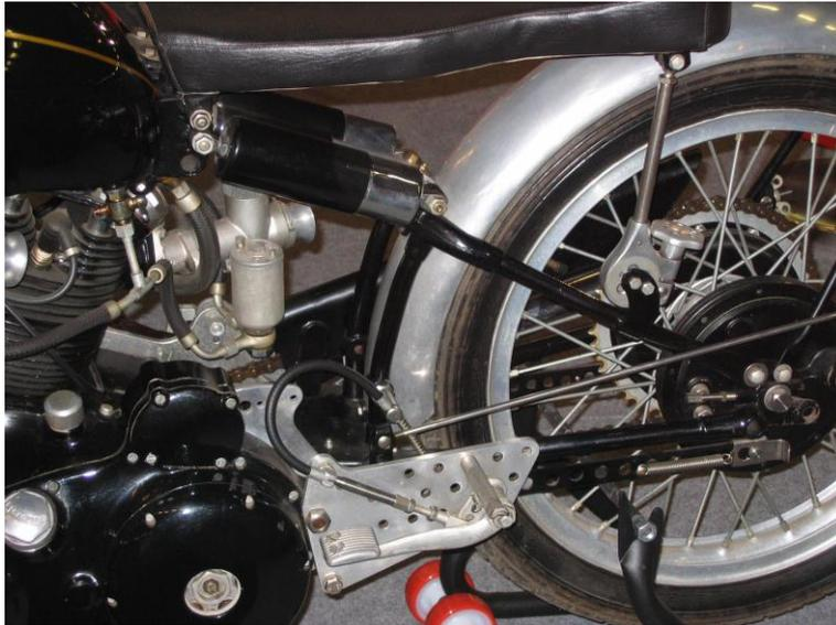
Figura 1.6. Suspensión trasera diseñada por Vincent-HRD. Extraída de [12].
