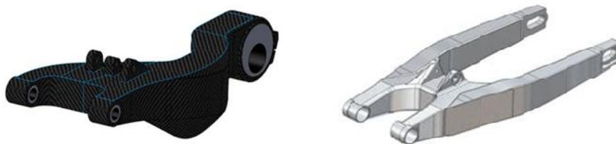
Figura 1.2. Basculantes monobrazo y doble brazo. Extraída de [5] y [6].
