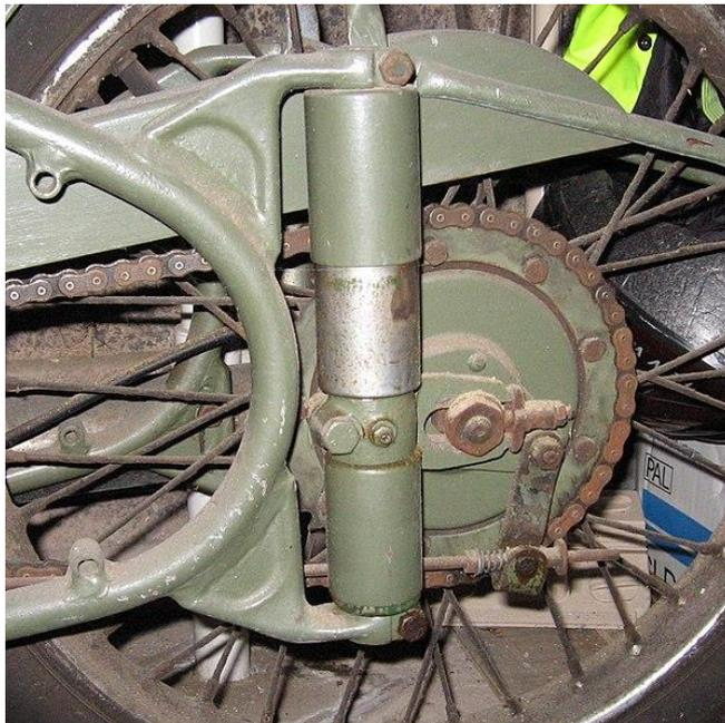
Figura 1.5. Suspensión trasera tipo Plunger de BSA Bantam. Extraída de [11].
