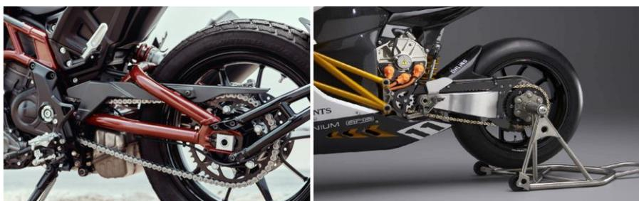
Figura 1.3. Basculantes tipo tubular y tipo viga. Extraída de [7] y [8].
