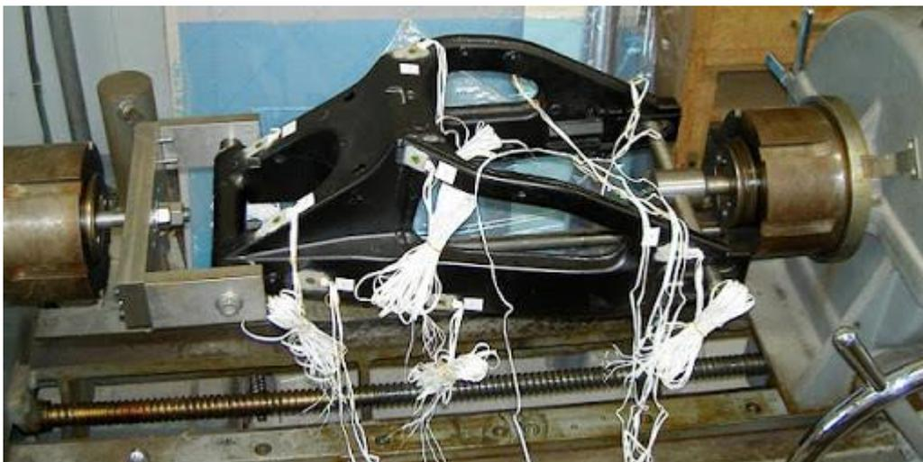
Figura 5.4. Basculante sometido a ensayo de rigidez torsional. Extraída de [21].
