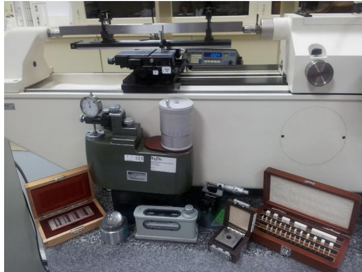
Figura 10: Instrumentos de calibración y patrones de un laboratorio de metrología dimensional. [20]
