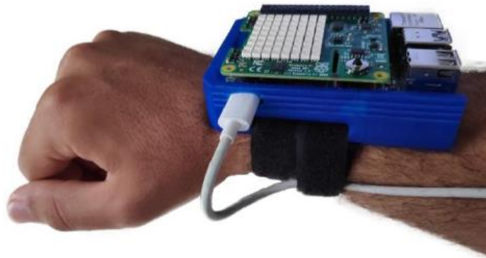
Figura 25. Soporte + Sense Hat + Raspberry pi + Cable alimentación. Disponible en [7].
