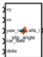
Figura 4.13 Bloque funcional para el cálculo del ángulo de deslizamiento (Caso concreto de la rueda 1).
