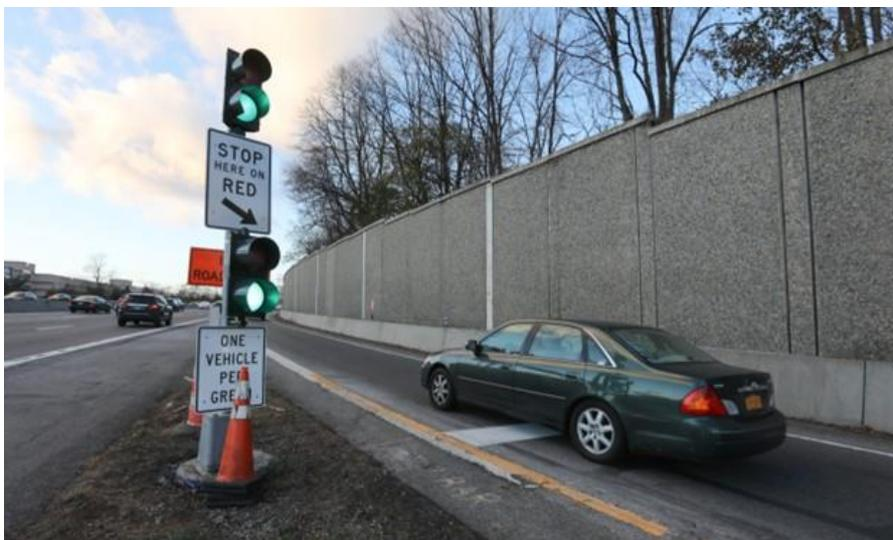
Figura 1-4. Semáforo instalado en una incorporación.
