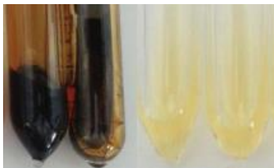
Ilustración 15. Comparación DBO/BP y Helisol 5A después de 10 días a 465^{\circ}\text{C} [38]
