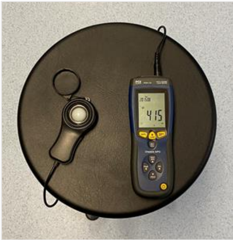
Fig. 49. Imagen del medidor PCE-174 durante la medición. Elaboración propia.
