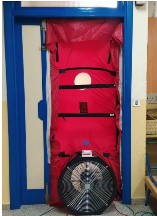
Fig. 19 Test en presurización (izquierda). Fuente: Fotografía propia
