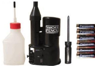
Fig. 18 Equipo Smoke Pencil. Fuente: https://www.conservationmart.com/p-6960-smoke-pencil-pro-soft-field-kit-sp-prosoftkit.aspx
