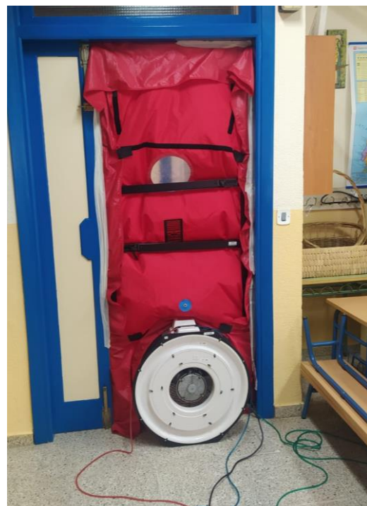
Fig. 20 Test en despresurización (derecha). Fuente: Fotografía propia
