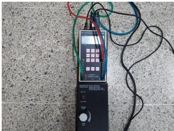
Fig. 16 Manómetro del Equipo Blower Door. Fuente: Fotografía propia
