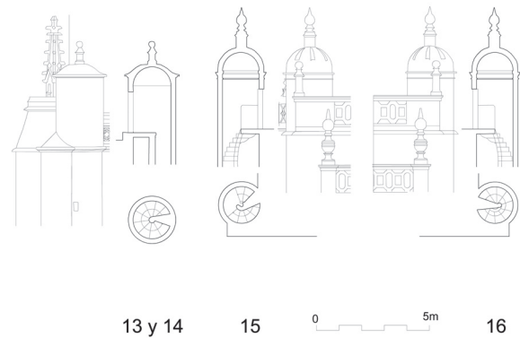
Figura 8. Alzados, secciones y plantas de las escaleras del tercer grupo. El número es el ID de la tabla. (Dibujos del autor).
