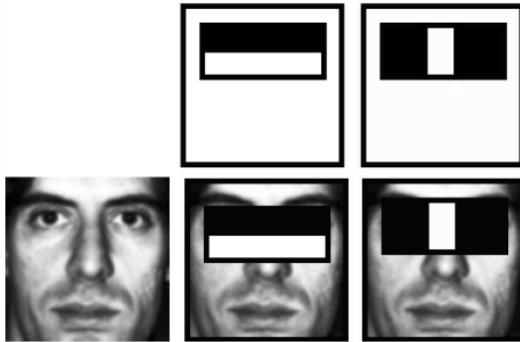
Figura 3.2: De izquierda a derecha: Imagen utilizada para el test, primer descriptor seleccionado por AdaBoost, segundo descriptor seleccionado por AdaBoost. Fuente: Viola and Jones (2001) [32].
