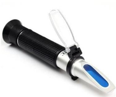
**Figura 5.** Refractómetro para medida de Materia Seca Soluble ATAGO N-1.
