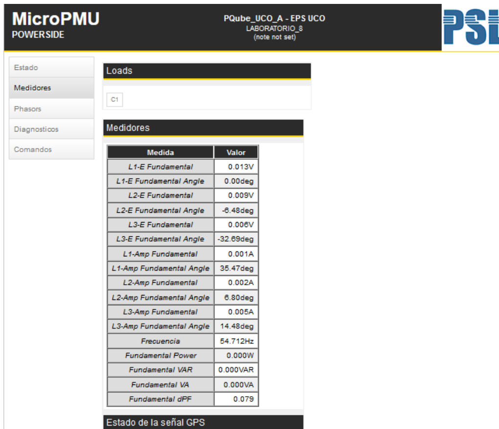
Figura 9. Interfaz Web de la \mu PMU de PowerSide.
