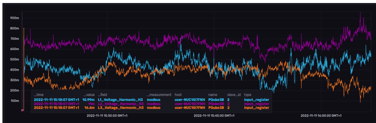
Figura 68. Valor del armónico 3 durante los primeros 40 min. Azul: bombilla 1, Rosa: bombilla 2, Naranja: bombilla 3
