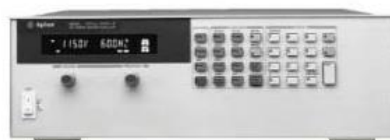
Figura 25. Fuente monofásica Agilet 6811B
