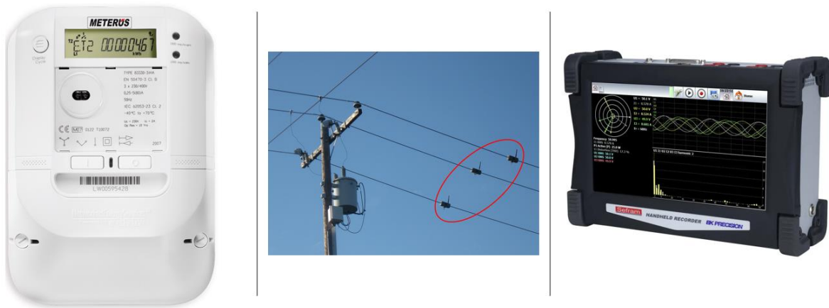
Figura 4. De izquierda a derecha, medidor inteligente en uso en Europa, sensores inalámbricos de línea y un registrador de eventos
