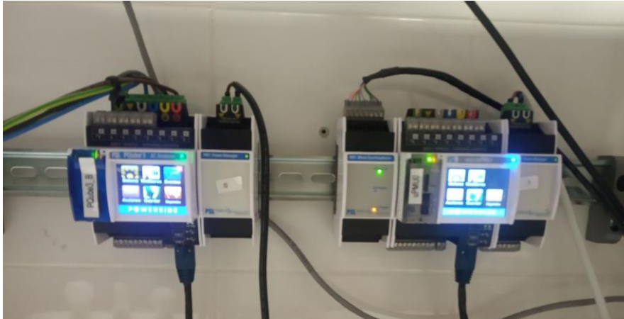
Figura 27. PQube3 (izq.) y \mu PMU (dcha.) sobre un carril DIN
