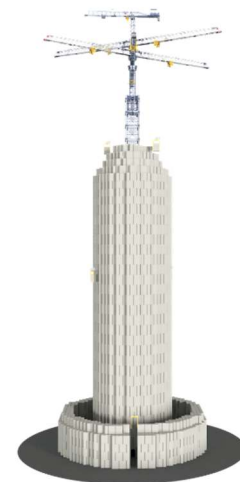
Fig. 17: Idea de almacenamiento por apilamiento de bloques de Energy Vault [38]
