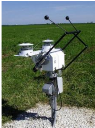
Figura 9: Piranómetro con disco solar [37]
