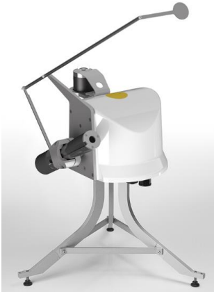
Figura 10: Pirheliómetro con sistema de seguimiento solar [38]
