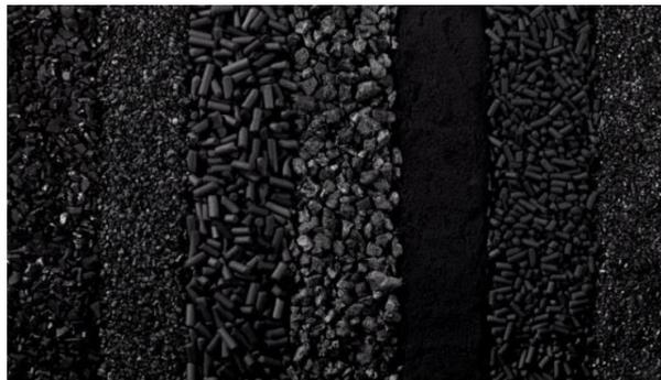
*Figura 18.* Tipos de carbón activado (16)
