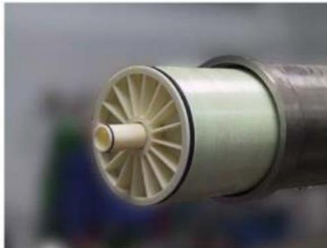
*Figura 19.* Módulo de membrana (16)
