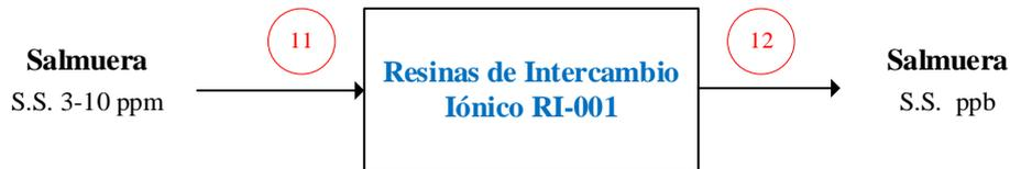
Figura 28. BM Resinas de Intercambio Iónico
