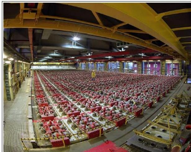
*Figura 3.* Sala de celdas de mercurio (5)
