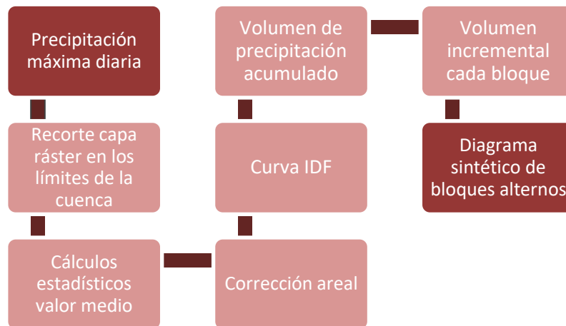
Figura 3-4. Esquema del proceso de obtención del hietograma de bloques alternos.
