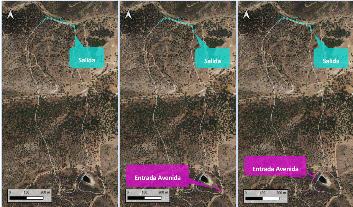
Figura 4-20. Condiciones de contorno del modelo de cálculo hidráulico en los tres escenarios planteados: escenario de rotura, escenario límite, escenario en régimen natural (sin presa).
