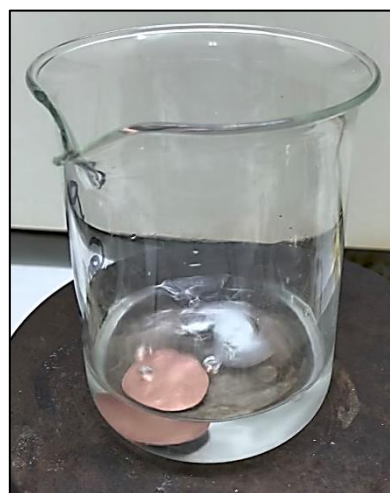
Figura 3-8 Proceso de autodeposición en plancheta de cobre
