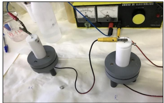
Figura 3-7 Montaje experimental de células de electrodeposición
