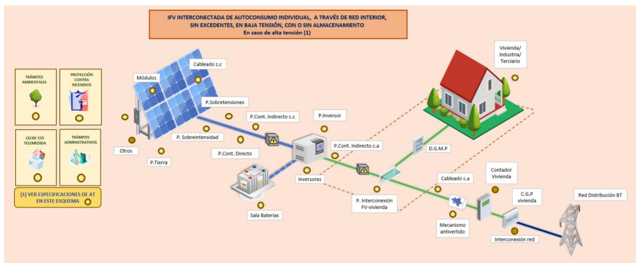
Figura 50: Ventana IFV interconectada de autoconsumo individual, a través de red interior, sin excedentes, en baja tensión, con o sin almacenamiento
