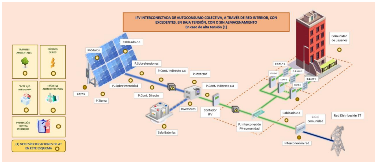
Figura 49: Ventana IFV interconectada de autoconsumo colectiva, a través de red interior, con excedentes, en baja tensión, con o sin almacenamiento
