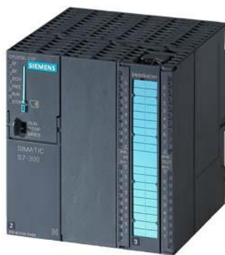
Figura 2-3. CPU SIEMENS 313-2 DP 6CF03-0AB0
