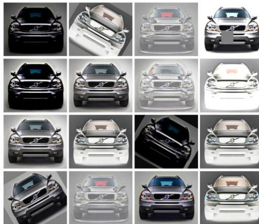
Figura 3-8. Ejemplo de data augmentation [12].
