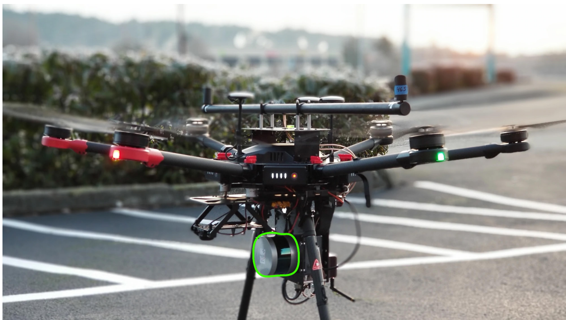
Figura 1.3 DJI Matrice 600 equipado con LiDAR Velodyne VLP 16.
