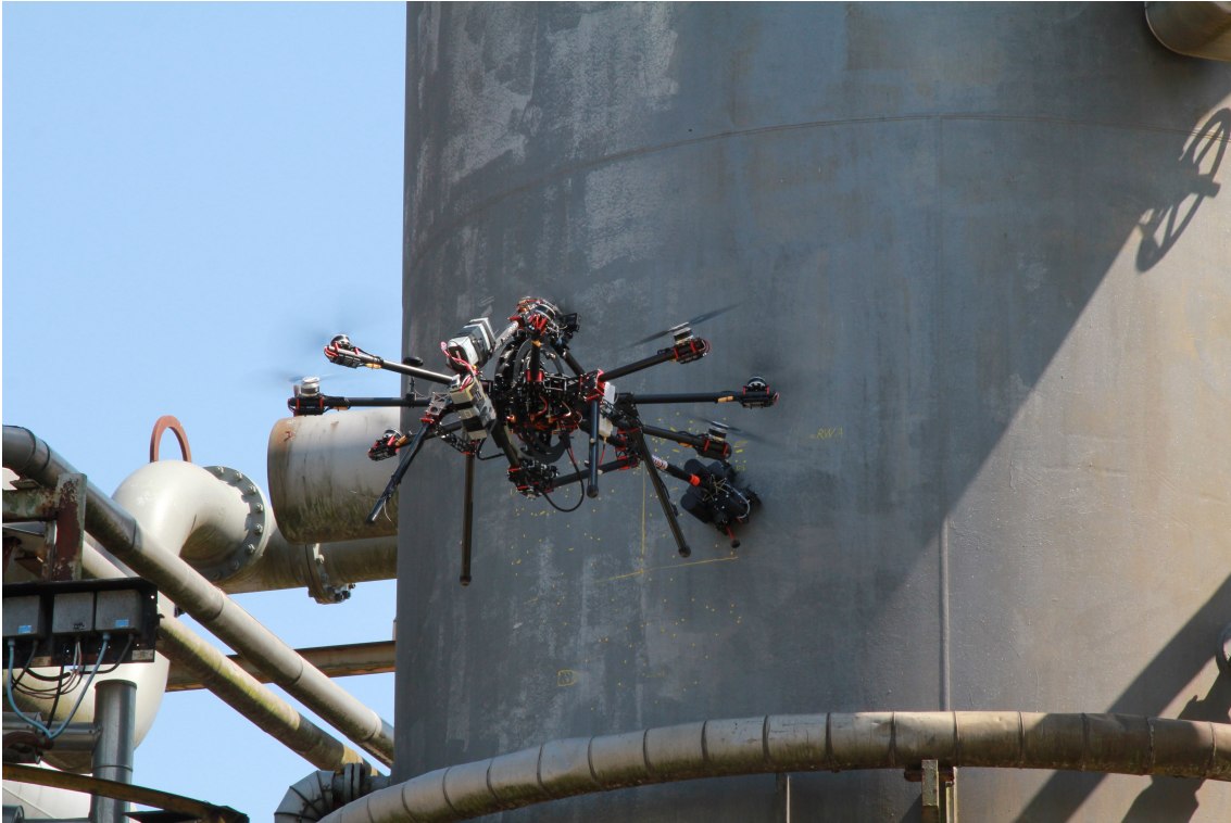
Figura 1.2 Dron para inspección de superficies por contacto, proyecto AEROARMS H2020.
