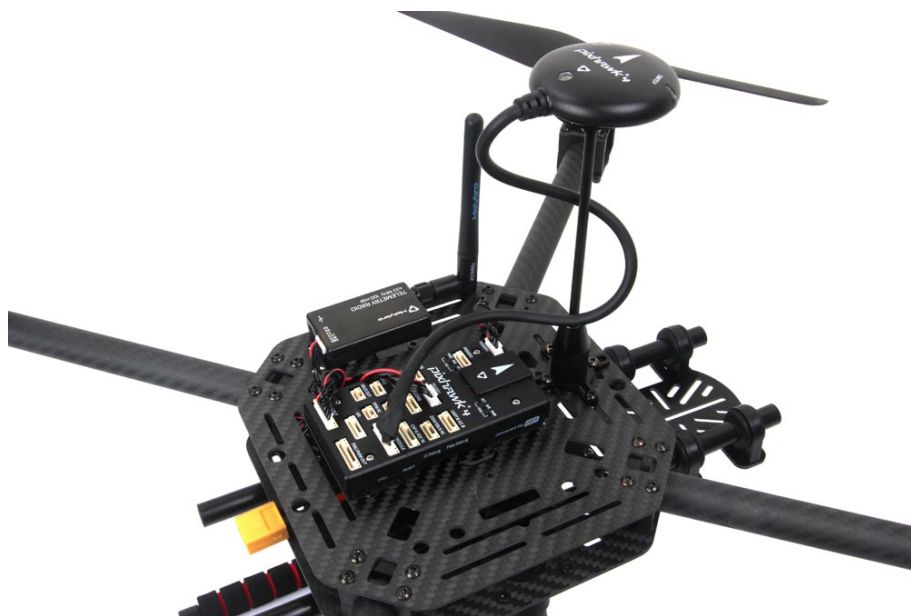
Figura A.2 Autopiloto Pixhawk 4 basado en FMUv5.
