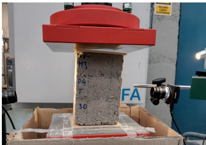
Figura 4.12. Probeta 30 días sin refrentar, Ensayo a compresión simple
