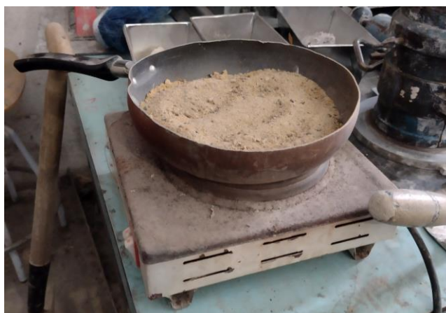
Figura 3.6. Medición humedad con sartén
