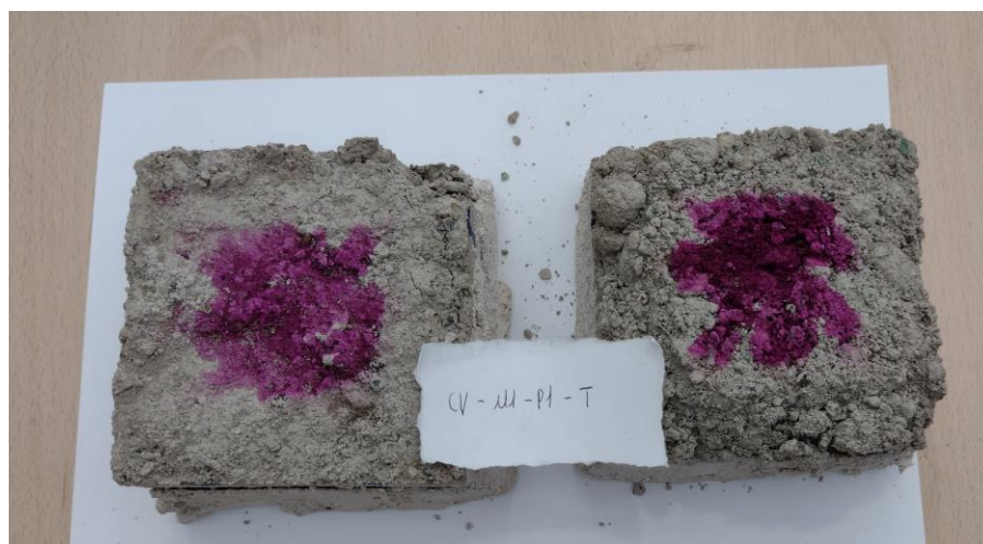
Figura 5.53. Prueba de carbonatación, probeta CV-120-M1-P1-T
