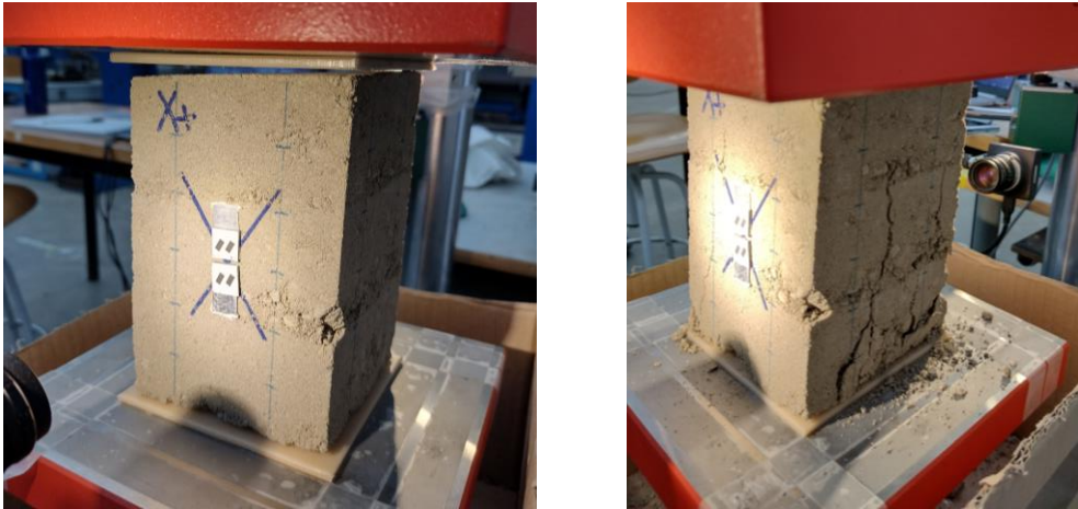
Figura 5.46. Probeta 30-SV-M3-P4-T antes/después ensayo a compresión
