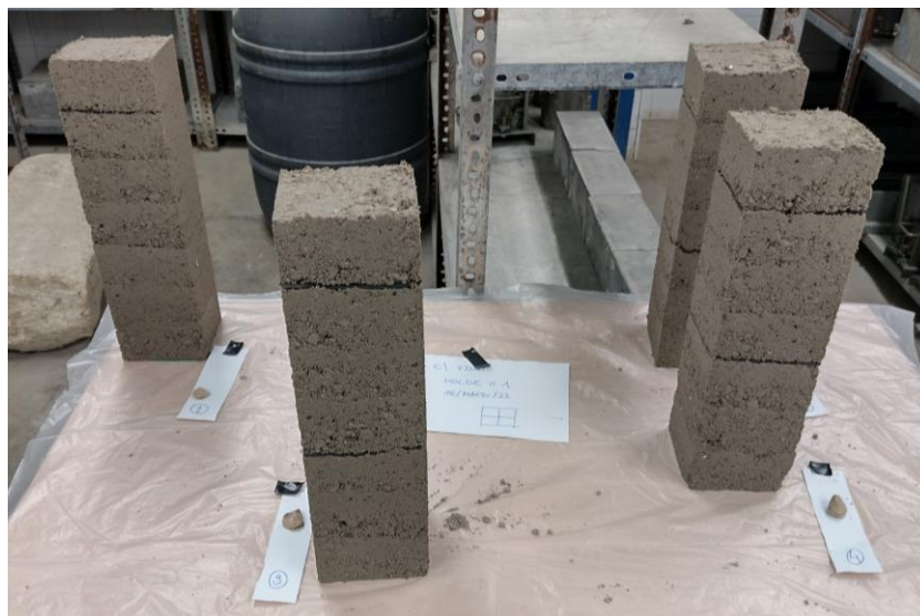
Figura 3.11. Secado probetas con vidrio
