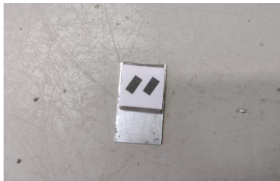
Figura 4.9. Patrón tarado en 5 mm sobre pletina metálica
