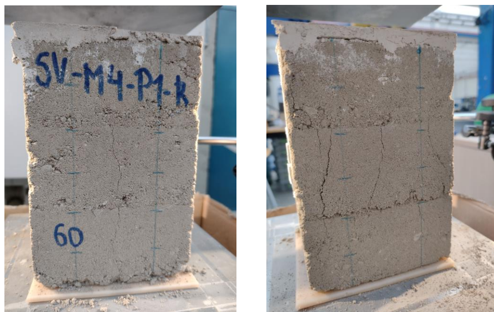
Figura 5.48. Probeta 60-SV-M4-P1-B después ensayo a compresión
