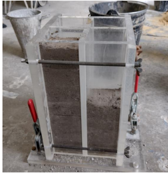
Figura 3.8. Probetas compactadas en el molde
