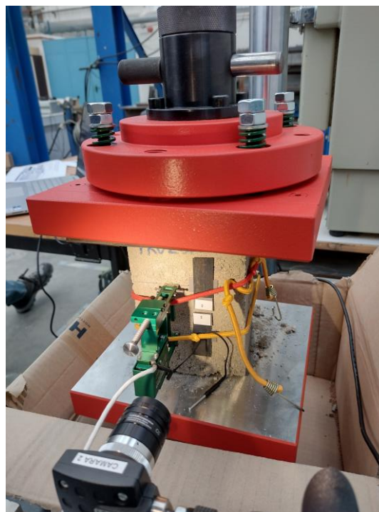
Figura 4.5. Sistema de videextensometría y extensómetro, ensayo a compresión simple
