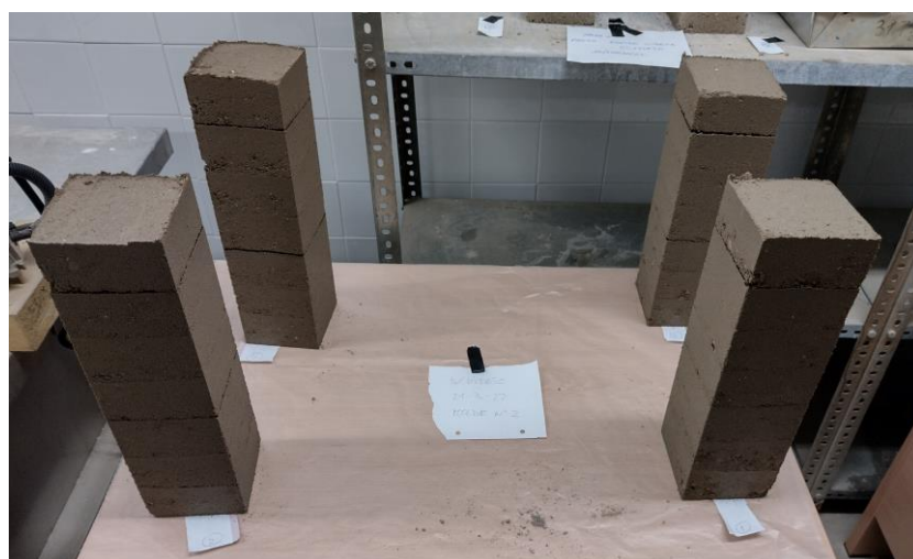
Figura 3.12. Secado probetas sin vidrio
