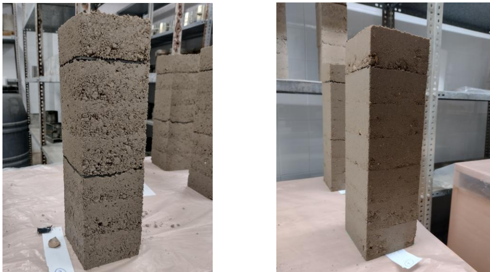
Figura 3.9. Probetas columna con vidrio (izquierda) y sin vidrio (derecha)
