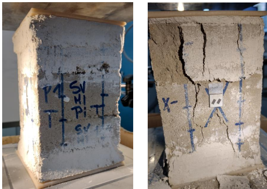
Figura 5.52. Probeta 120-SV-M1-P1-T antes/después ensayo a compresión
