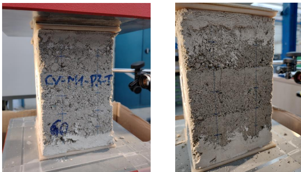
Figura 5.47. Probeta 60-CV-M1-P3-T antes/después ensayo a compresión
