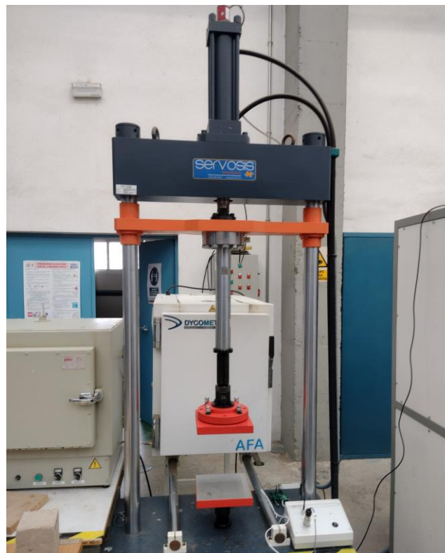
Figura 4.2. Máquina hidráulica ensayo a compresión
