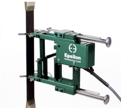
Figura 4.3. Extensómetro, ensayo a compresión simple
