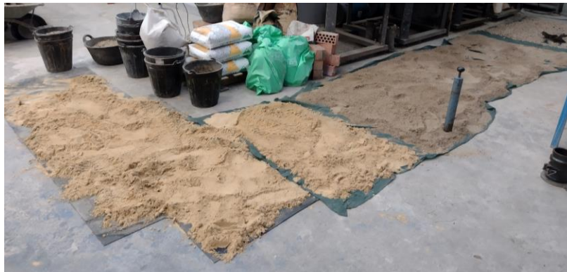
Figura 3.5. Arcilla, limo, arena y grava empleados en la mezcla, Laboratorios ETSI
