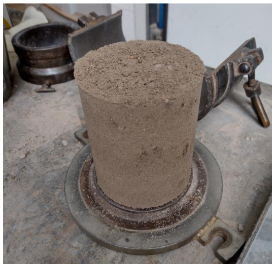
Figura 2.8. Muestra compactada y desmoldada, Ensayo Próctor Normal
