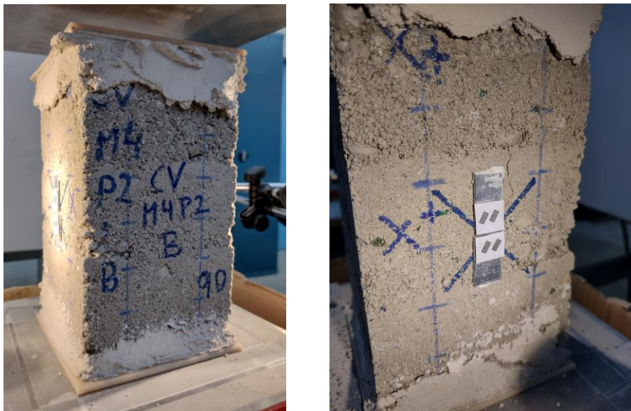
Figura 5.49. Probeta 90-CV-M4-P2-B antes/después ensayo a compresión
