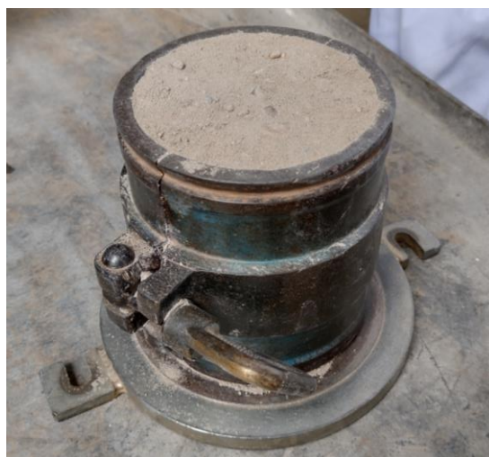
Figura 2.7. Molde con muestra compactada, Ensayo Próctor Normal
