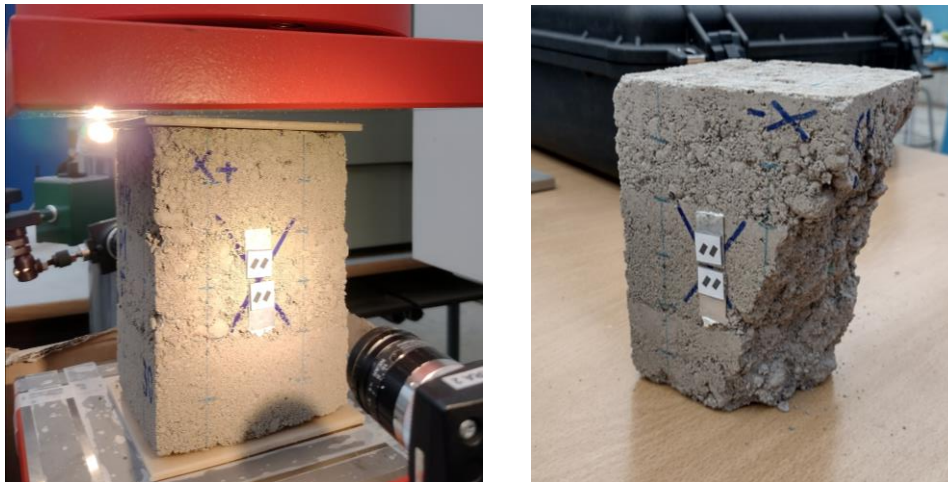
Figura 5.44. Probeta 30-CV-M4-P1-T antes/después ensayo a compresión
