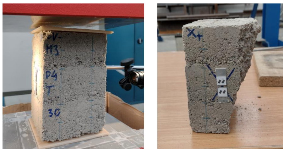
Figura 5.45. Probeta 30-CV-M3-P4-T antes/después ensayo a compresión
