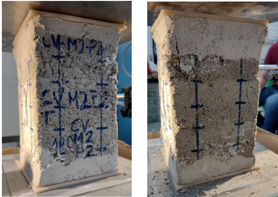
Figura 5.51. Probeta 120-CV-M2-P2-T antes/después ensayo a compresión
