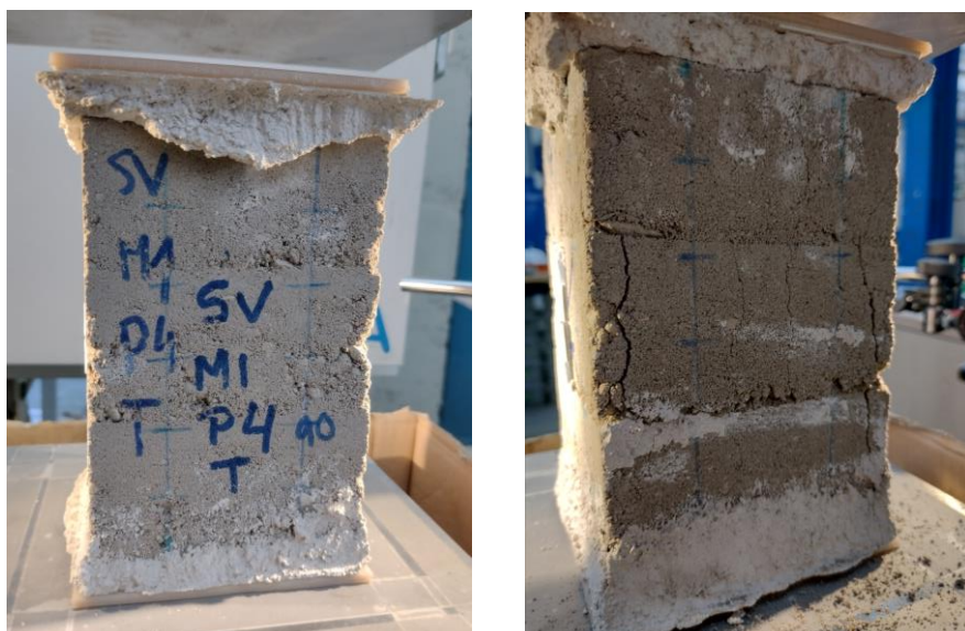
Figura 5.50. Probeta 90-SV-M1-P4-T antes/después ensayo a compresión
