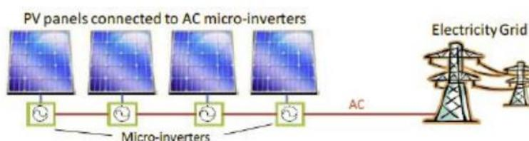
Figura 15. Ejemplo de disposición de microinversores [8]
