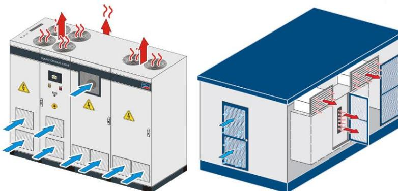
El intercambiador de calor externo está ubicado en la parte exterior del conversor y es el responsable de disipar el calor del líquido refrigerante al medio ambiente.
