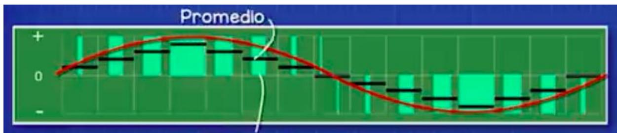
Figura 5. Representación de la Corriente de salida del módulo IGBT monofásico
