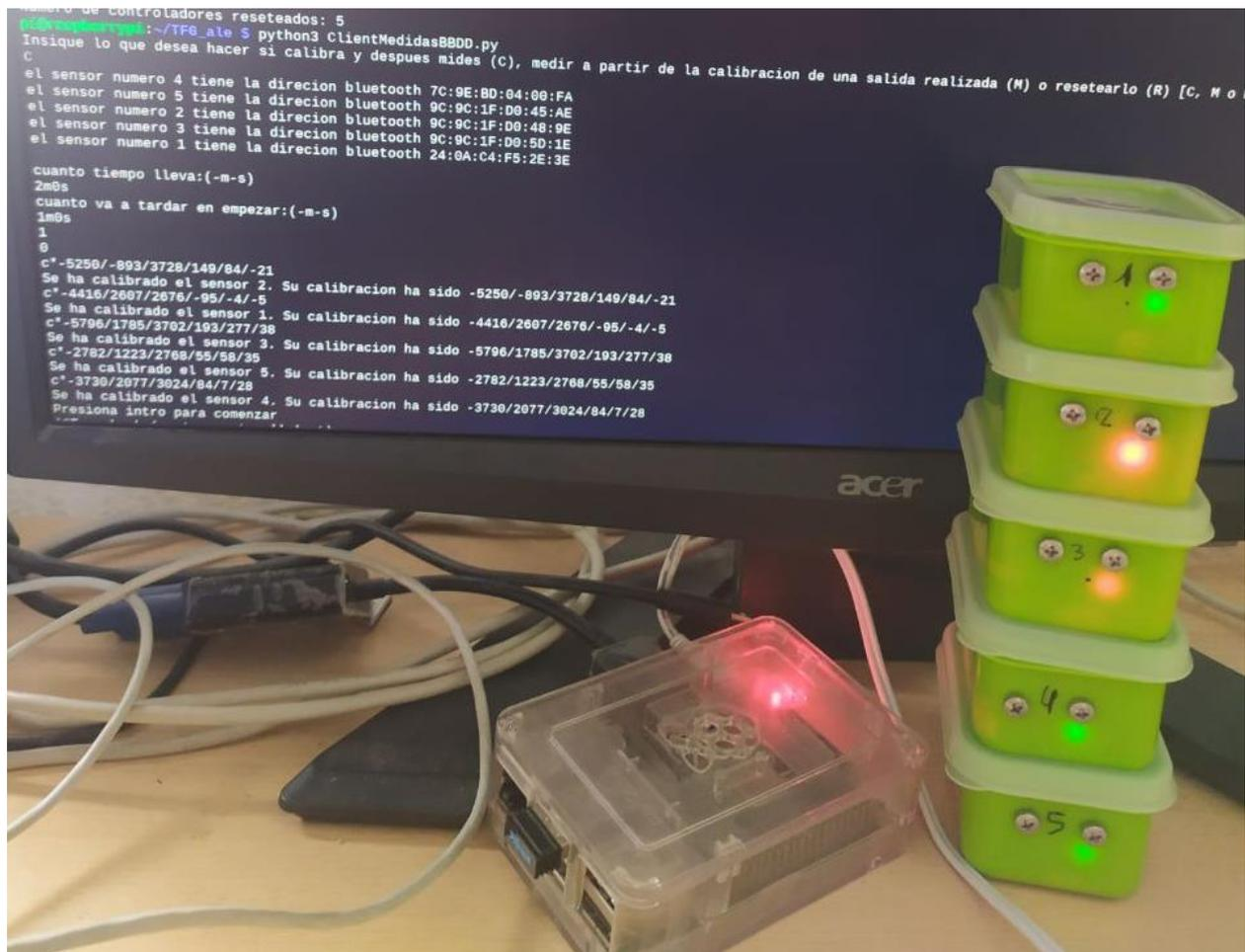
Ilustración 4.4-1. Interfaz creada para realizar una medida. Se puede ver como todos las **IMUs** han tenido que estar conectados para calibrar los sensores y empezar a medir.
