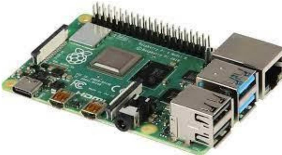
Ilustración 3.8-1. Raspberry pi 4 modelo B (73).
