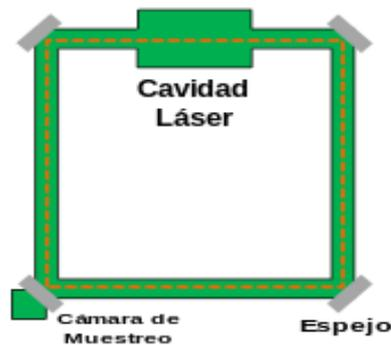
Ilustración 3.4-4. Giroscopio óptico (33).
