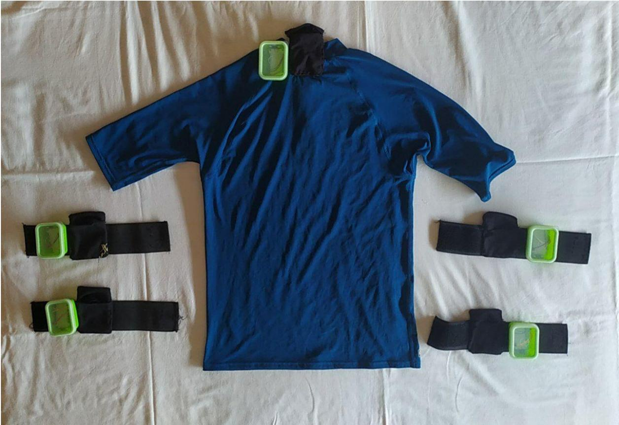
Ilustración 5.2-1. Traje realizado para fijar los sensores a cada parte del cuerpo.
