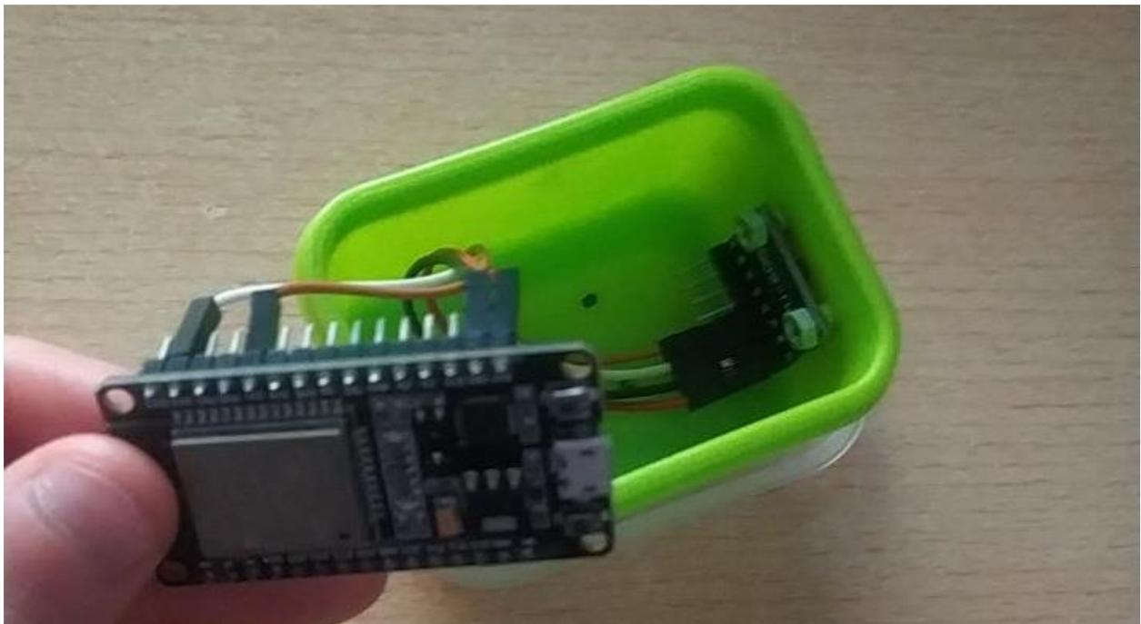
Ilustración 4.2-1. Imagen del módulo sensor. Se puede observar cómo está conectado el microcontrolador ESP 32 (microchip negro) a la **IMU MPU 6050** (atornillador al recipiente) mediante I2C.
