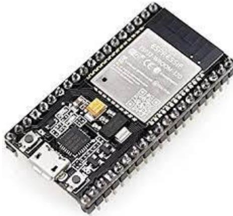
Ilustración 3.6-2. Placa ESP 32 WROOM 32 (55).
