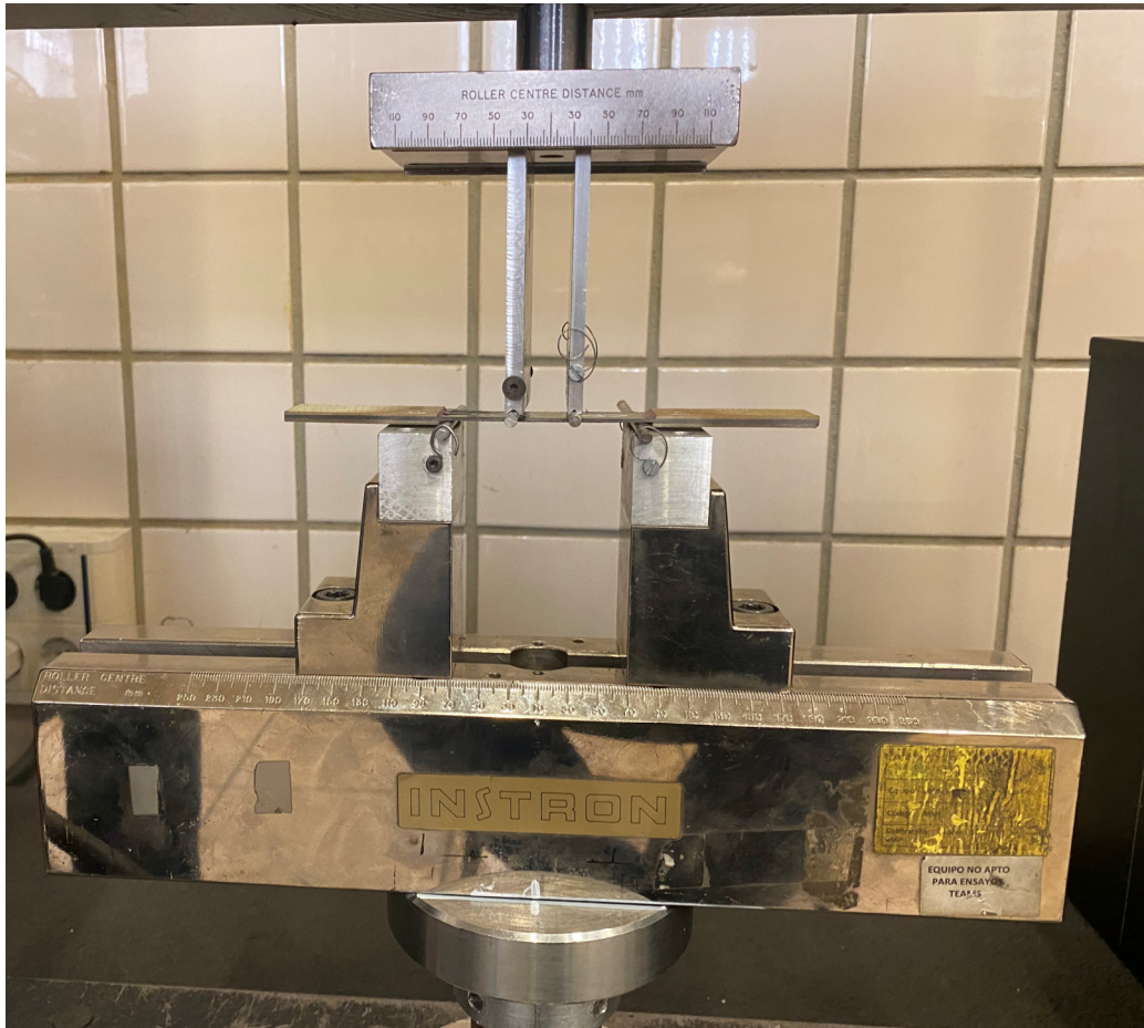
Figura 23: Útiles del ensayo a flexión con los datos especificados en la tabla [3].
