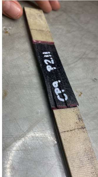
Figura 26: Probeta CP30 PD2_1 con fibras en la capa de 0° despegadas.
