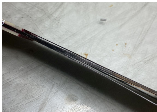
Figura 25: Probeta CP30 PD2_1 con fibras en la capa de 0^\circ despegadas.
