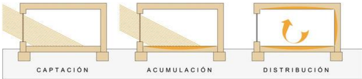
Figura 1.9- Sistema solar pasivo directo. Fuente: CertificacionEnergeticaSalamanca
