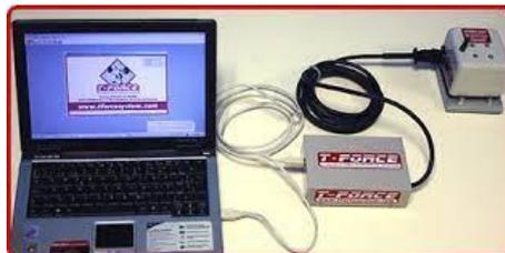
**Ilustración 2 Transductor lineal (T-Force)**
