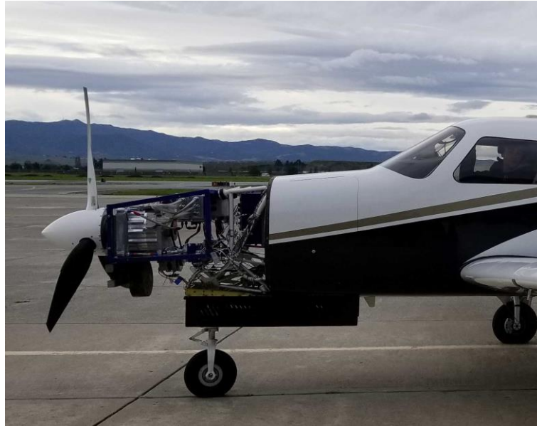
Figura 4.27. Unidad de potencia de la Piper Matrix de ZeroAvia [104]
