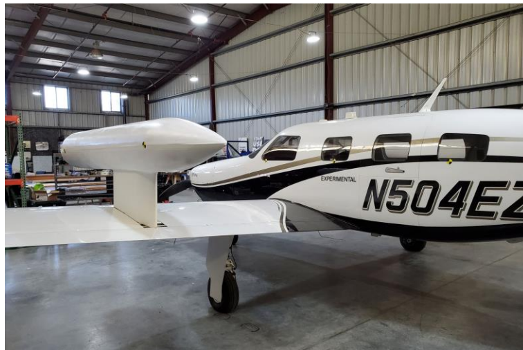
Figura 4.26. Piper Matrix de ZeroAvia con el tanque de hidrógeno externo [103]
