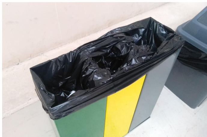
Figura 3.17. Demostración de la imposibilidad de colocar una bolsa para cada compartimento del denominado contenedor triple 2.
