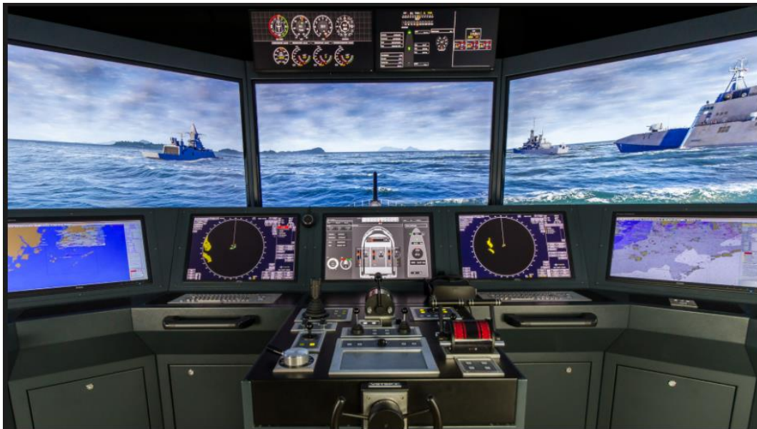
Figura 2. Simulador de navegación y maniobras creado por la empresa VSTEP extraído de [2].
