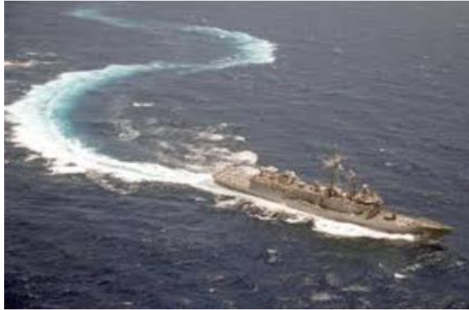
Figura 22. Pruebas de maniobra zig-zag en la mar.
