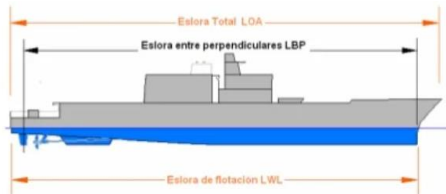
Figura 14. Distintos tipos de eslora de un buque extraída de [16].
