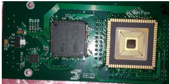
Figura 95. A la derecha de la placa, se encuentra el sensor de visión basado en eventos con foveación aplicada.
