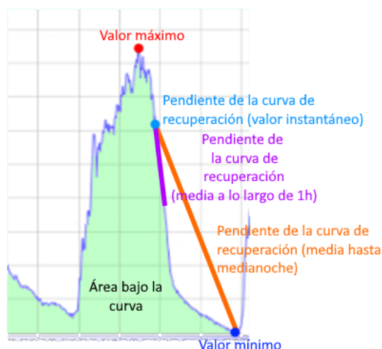
Figura 2.1 Estimadores de estrés hídrico a partir de sensores ZIM..
