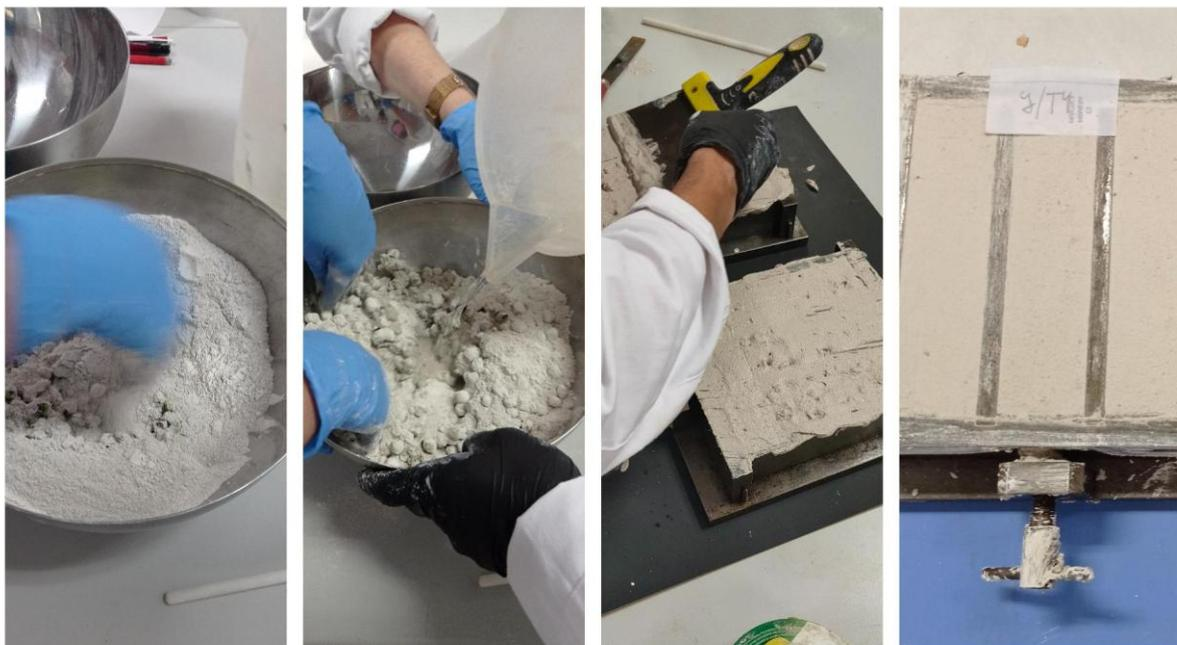
FIG\_31: Proceso de mezcla de los materiales y vertido en el molde de las probetas.
