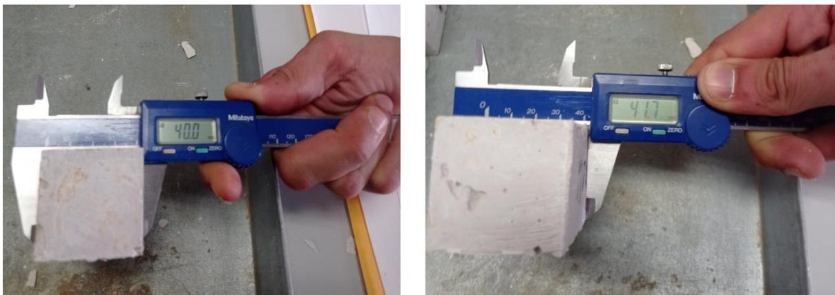
FIG\_33: Medida de precisión de las dimensiones de las probetas.
