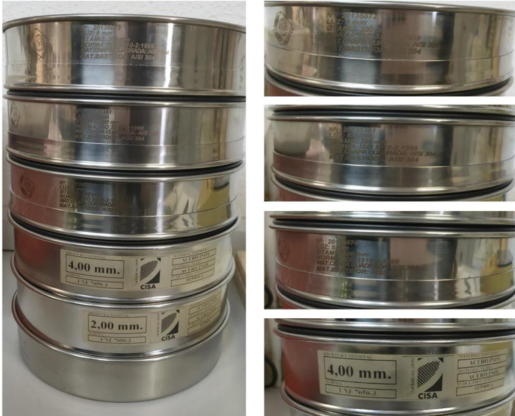
FIG\_25: Tamices utilizados para la granulometría.
