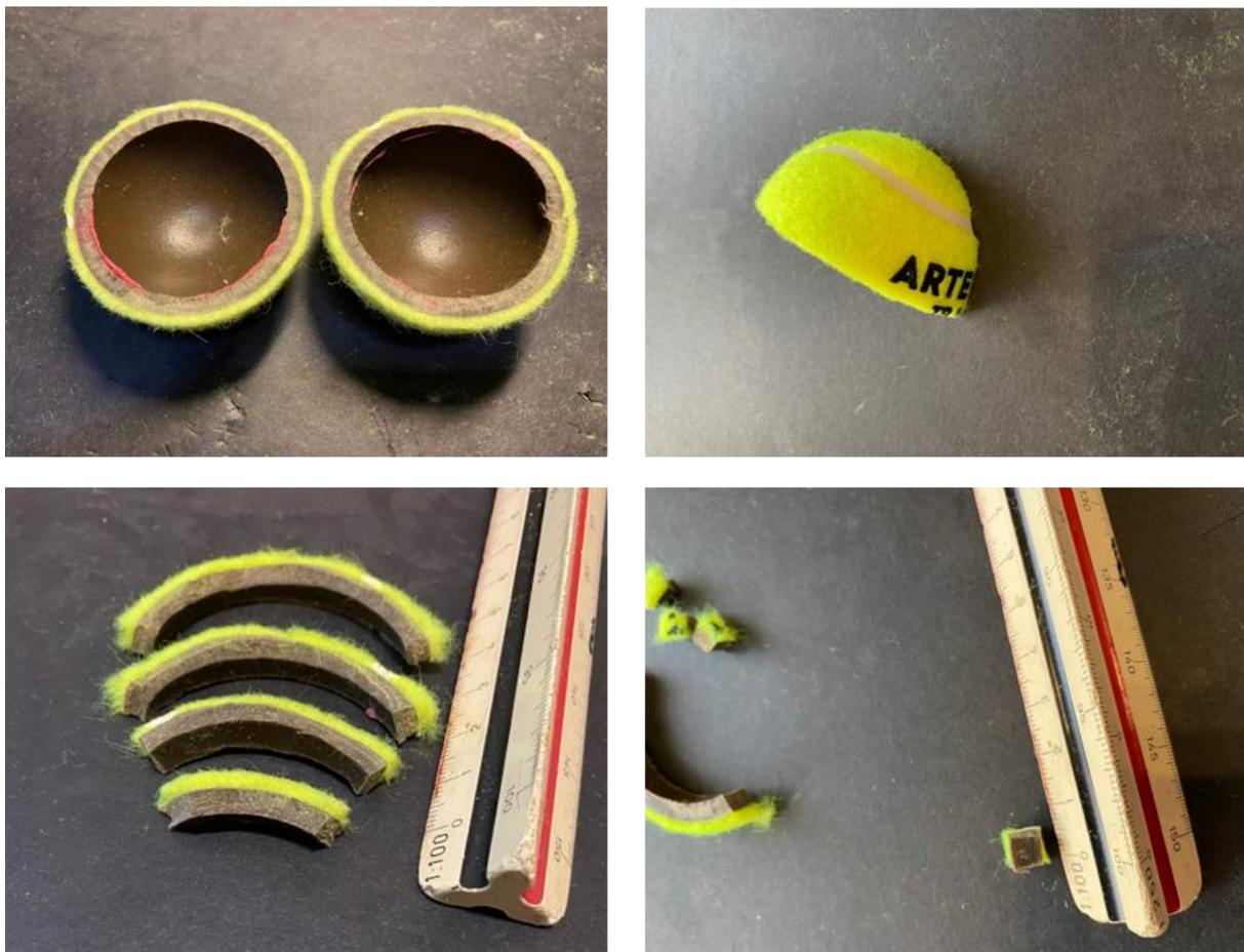
FIG\_24: Procedimiento de corte de las pelotas de tenis
