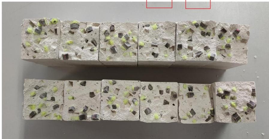
FIG\_38: Probetas con dosificación 12% tras rotura en ensayo de resistencia a flexión.
