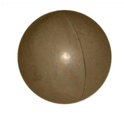
FIG\_11: Sellado de ambas semiesferas de caucho [27].
