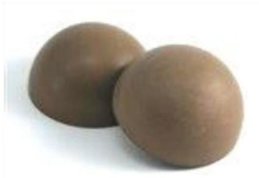
FIG\_10: Semiesferas de caucho para producir pelotas de tenis [27].
