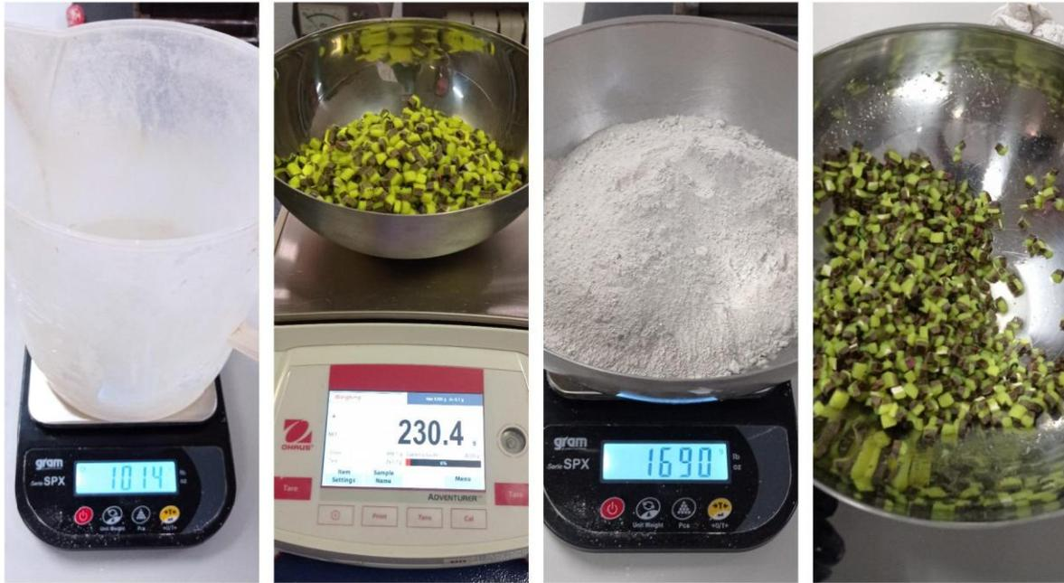
FIG\_30: Materiales pesados para la mezcla de yeso y residuos de pelotas de tenis.
