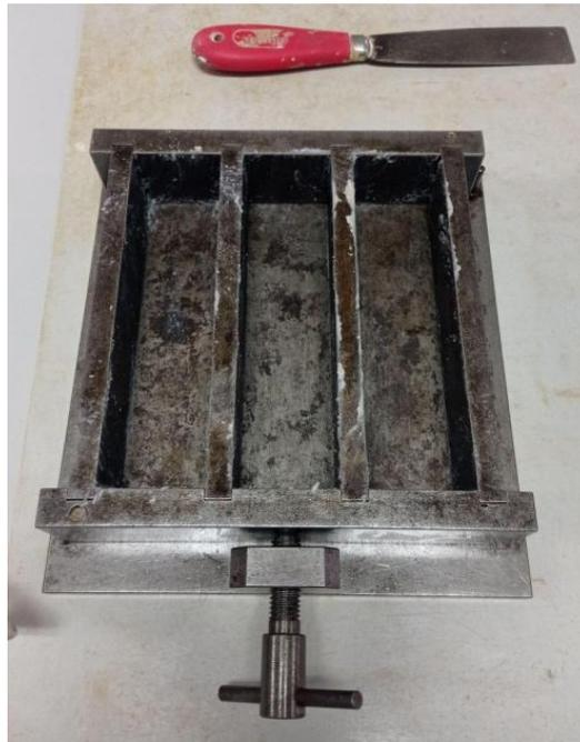
*FIG\_29: Molde de las probetas tras la aplicación del desencofrante*
