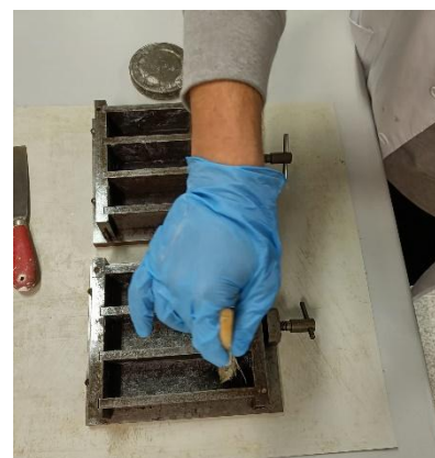
[Fig. 20] Aplicación de desencofrante en probeta Fuente: EP
