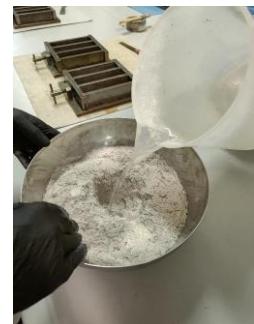
[Fig. 24] Vertido de agua en la mezcla Fuente: EP
