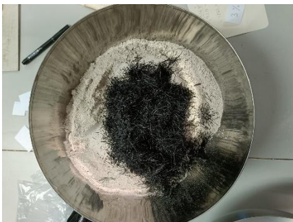
[Fig. 22] Vertido de fibras en yeso seco Fuente: EP
