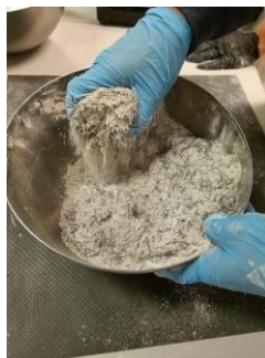
[Fig. 23] Mezclado fibras con yeso Fuente: EP
