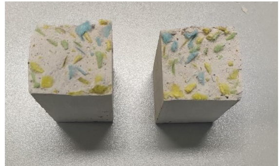
[Imagen 37]: Partes A y B de las probetas con 2% de aditivo. EP
