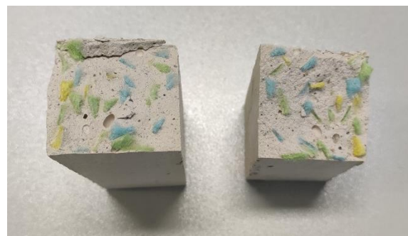
[Imagen 36]: Partes A y B de las probetas con 1,5% de aditivo. EP
