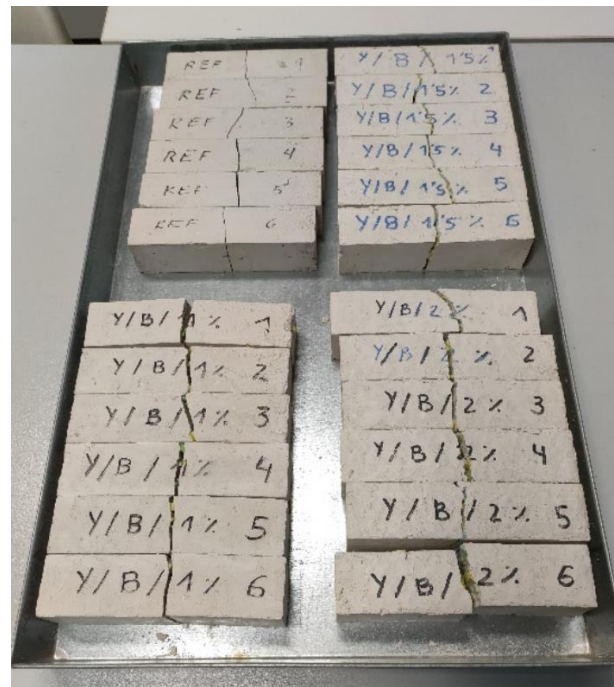
[Imagen 29]: Imagen de las probetas después del ensayo a flexión. EP
