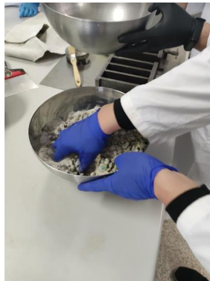
[Imagen 23]: Mezcla de agua con yeso y aditivo. EP
