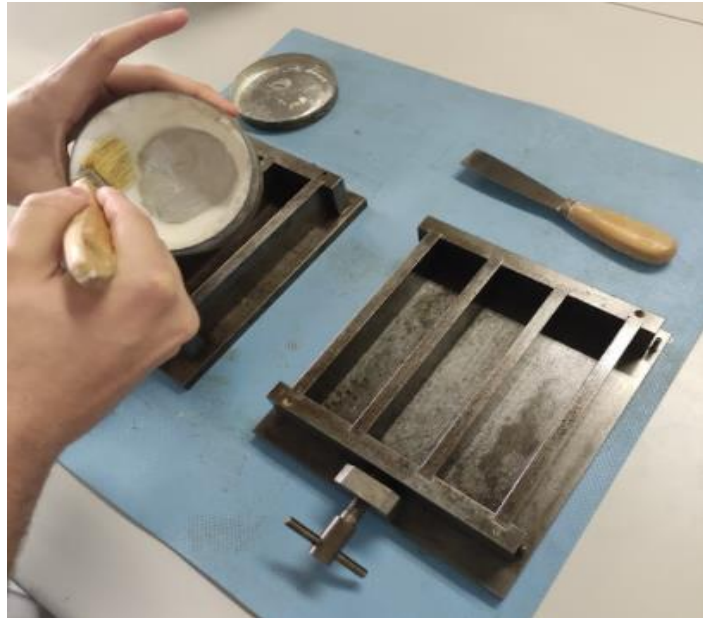
[Imagen 15]: Aplicación del desencofrante en los moldes de probetas. EP
