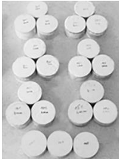
[Imagen 7]: Muestras para ensayo de Tubo de Kundt sin perforaciones y con apariencia lisa. FUENTE: https://doi.org/10.1016/J.CONBUILDMAT.2021.122625
