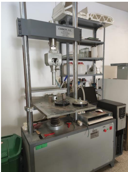
[Imagen 28]: Prensa de ensayo Codein S.L. usada en laboratorio. EP
