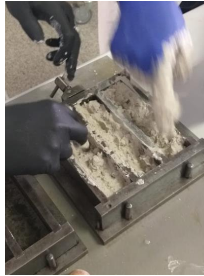
[Imagen 25]: Vertido y relleno completo de los moldes. EP
