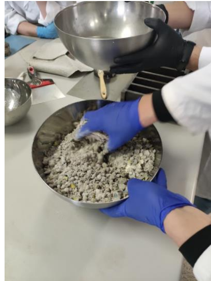
[Imagen 21]: Mezcla del aditivo con el yeso. EP
