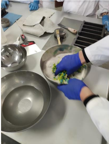
[Imagen 20]: Mezcla del aditivo con el yeso. EP
