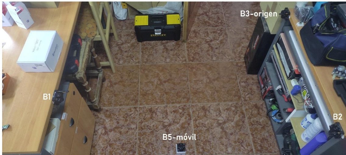
Ilustración 19: Colocación de las balizas para el ensayo, donde para B_i , i es el ID de la baliza.
