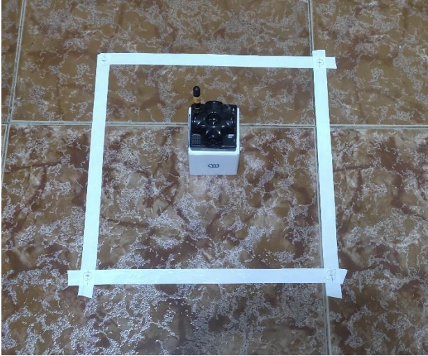
Ilustración 21: Cuadrado de 30x30 cm donde se colocará la baliza, moviéndose a cada una de las cuatro esquinas.
