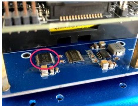
Ilustración 48: Revisión antigua, con un único controlador de motores. Imagen obtenida de [26].
