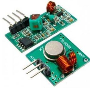
Ilustración 6: Módulos comunes RF 433, receptor (izquierda) y transmisor (derecha). Imagen cedida por [12].
