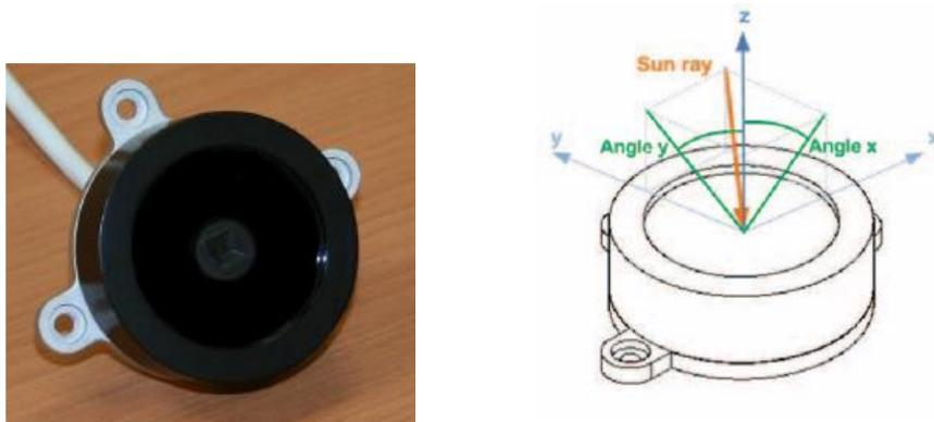
Figura 2-1. Solar MEMS, dispositivo y esquemático con sistema de referencia
