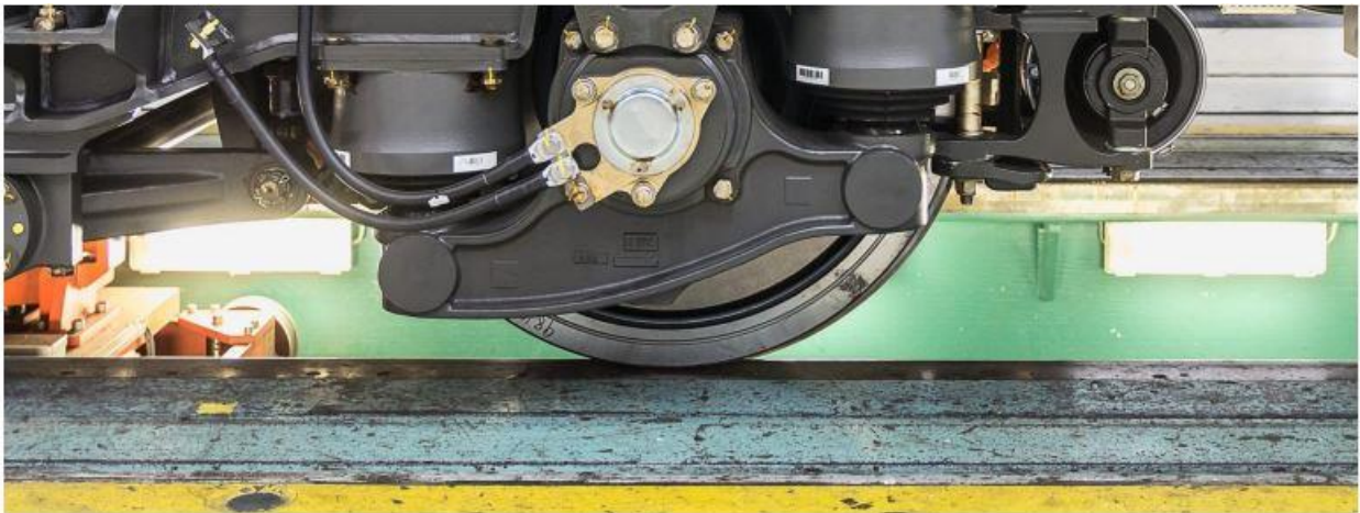
Figura 3.1. [6] Contacto de una rueda de tren con un rail.
