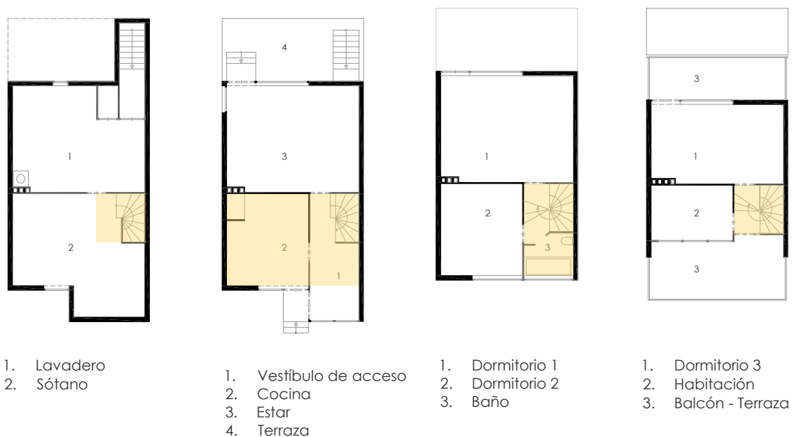
Figura: 39. Planta Sótano, Baja, Primera y Segunda elemento Kernhuis.
