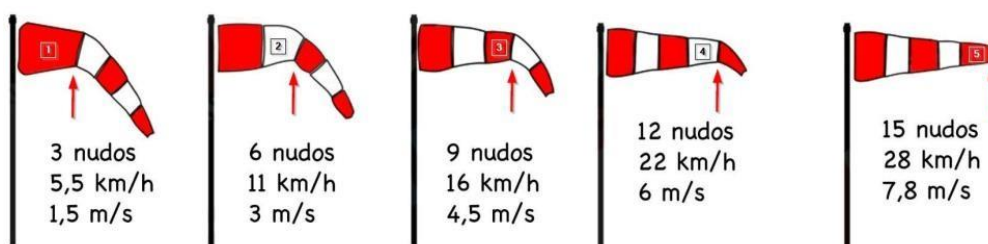
Ilustración 68. Lectura de un indicador de viento según velocidad del mismo.
