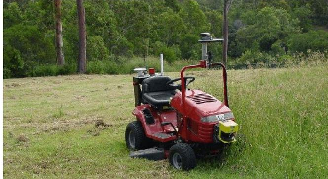
**Figura 2.4:** Vehículo autónomo con generador de trayectoria *lawn-mower*<sup>9</sup>.
