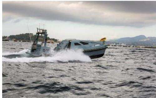
**Figura 2.2:** Vehículo no tripulado especializado en la detección y neutralización de minas acuáticas<sup>6</sup>.
