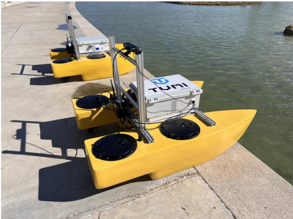
**Figura 1.7:** Vehículo ASV en entorno de pruebas, Sevilla
