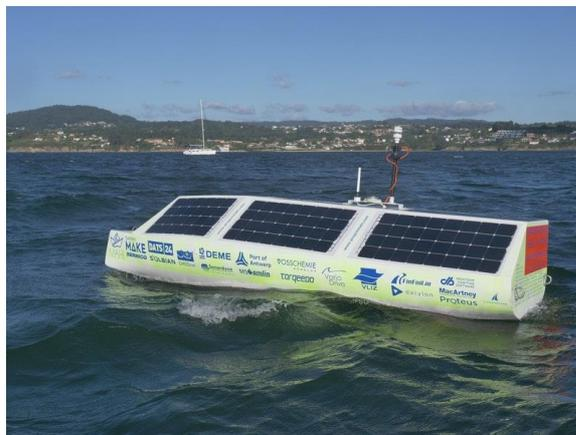
**Figura 1.10:** Vehículo no tripulado de superficie Mahi Two.
