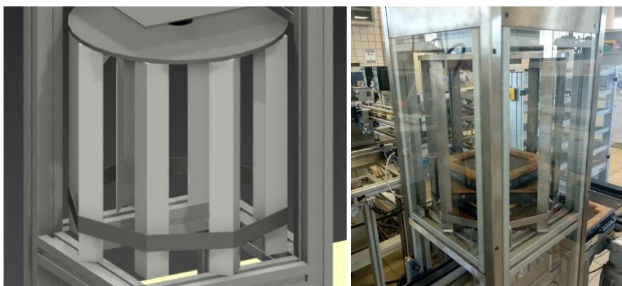
Figura 4.3 - Comparativa entre el modelo 3D y el cilindro de giro real.
