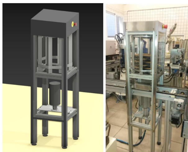
Figura 4.1 - Comparativa entre el modelo 3D y el real del alimentador de bandejas.
