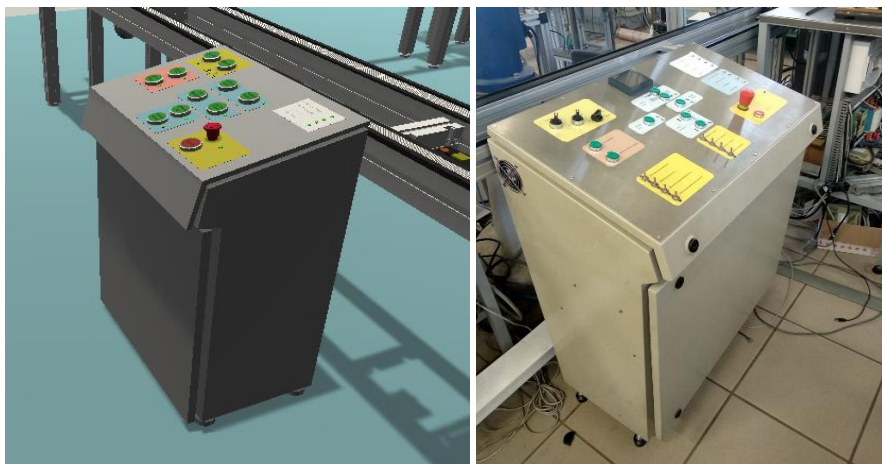
Figura 4.6 - Comparativa entre el modelo 3D y el cuadro de mandos real.
