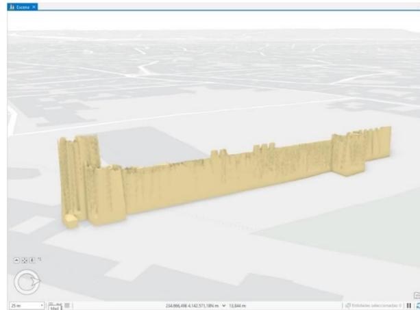
Fig. 43. Modelado 3D muralla LOD2 tras la aplicación de la herramienta Edificios multiparache LAS. Elaboración propia.
