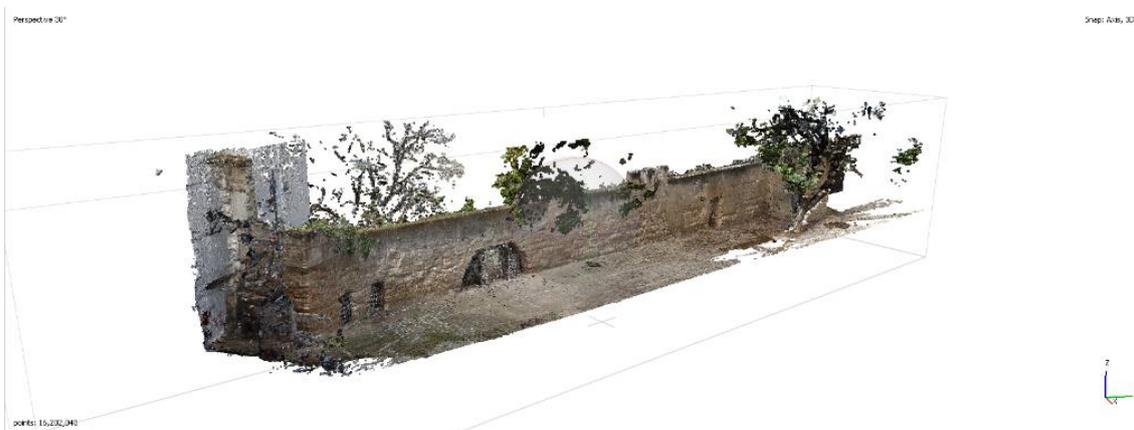
Fig. 9. Nube de puntos densa reducida, número de puntos: 16.202.043. Elaboración propia.
