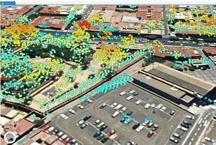
Fig. 15. Puntos LIDAR correspondientes a la clasificación de vegetación. Elaboración propia.
