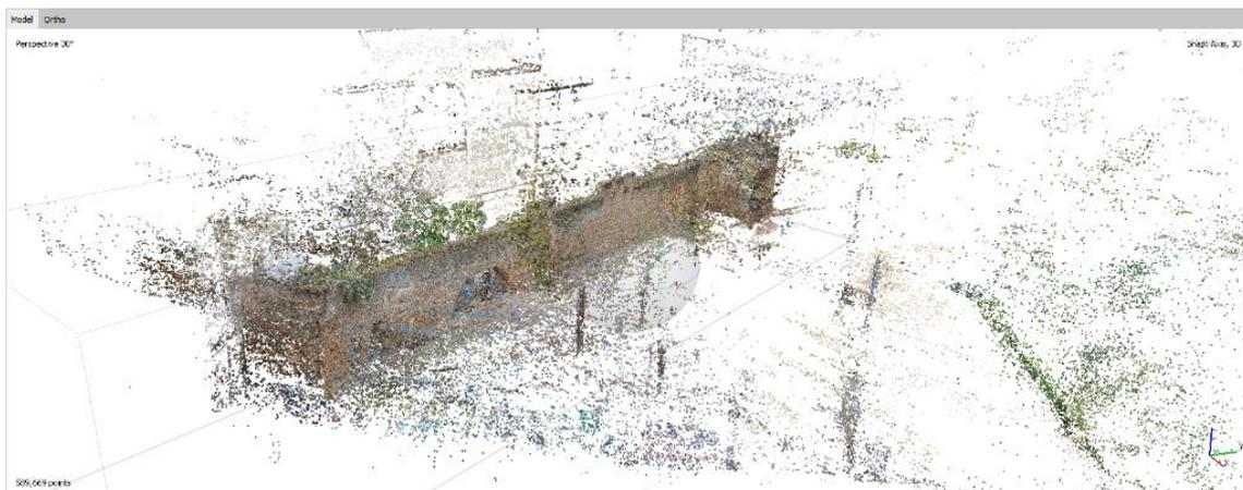
Fig.7. Puntos de paso, *Tie Points*, puntos originales de la fotogrametría, elaborada por Margarita Infante Perea y Concepción Cantillana Merchante.
