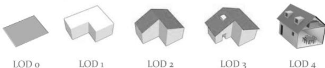
Fig.26. LOD (Level of detail) clasificación. Elaboración propia a partir de la información aportada por el CityGML.
