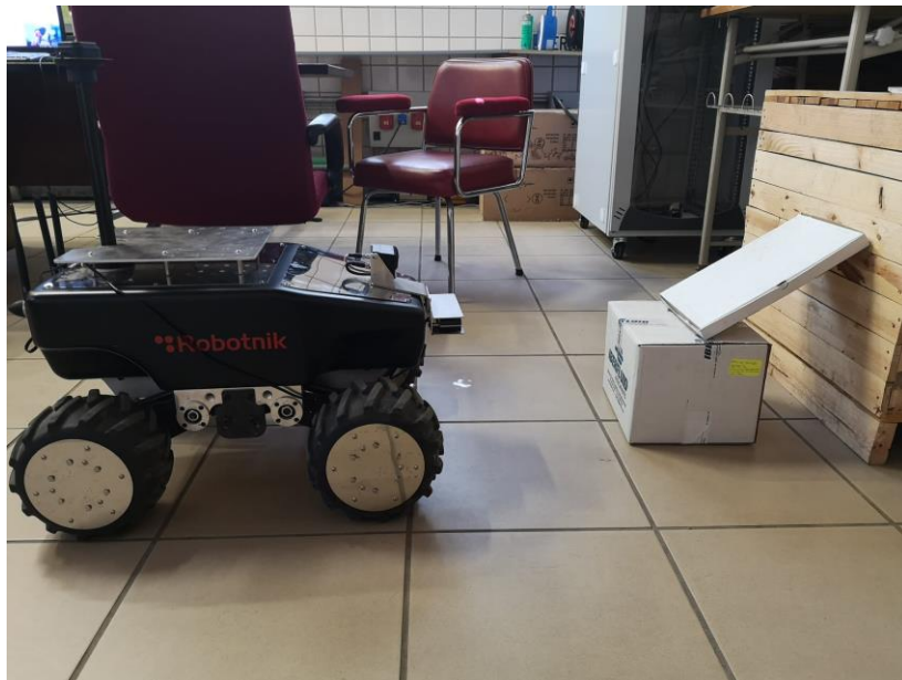
Figura 5-24. Experimento de pendientes en interior con caja poco inclinada.
