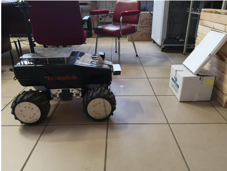
Figura 5-21. Experimento de pendientes en interior con caja muy inclinada.
